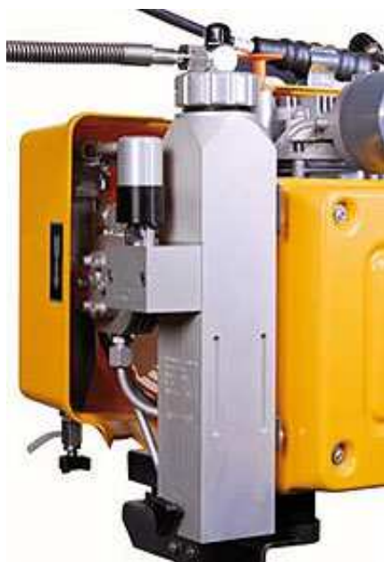
Sistema di filtrazione P11 per aria respirabile purissima
